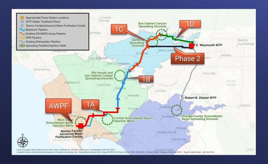
Phase 1A: 30 MGD Phase 1B: 10 MGD Phase 1C: 50 MGD Phase 1D: 25 MGD Phase 2: 35 MGD Total: 150 MGD
